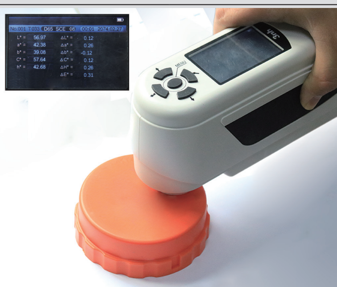
Messung von \Delta E an einem Gehäusedeckel
